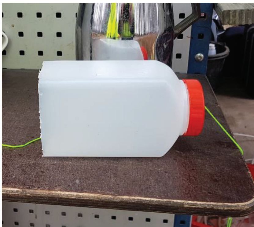
Figur 3.2-1: Fugtsikring af ORSA-rør
